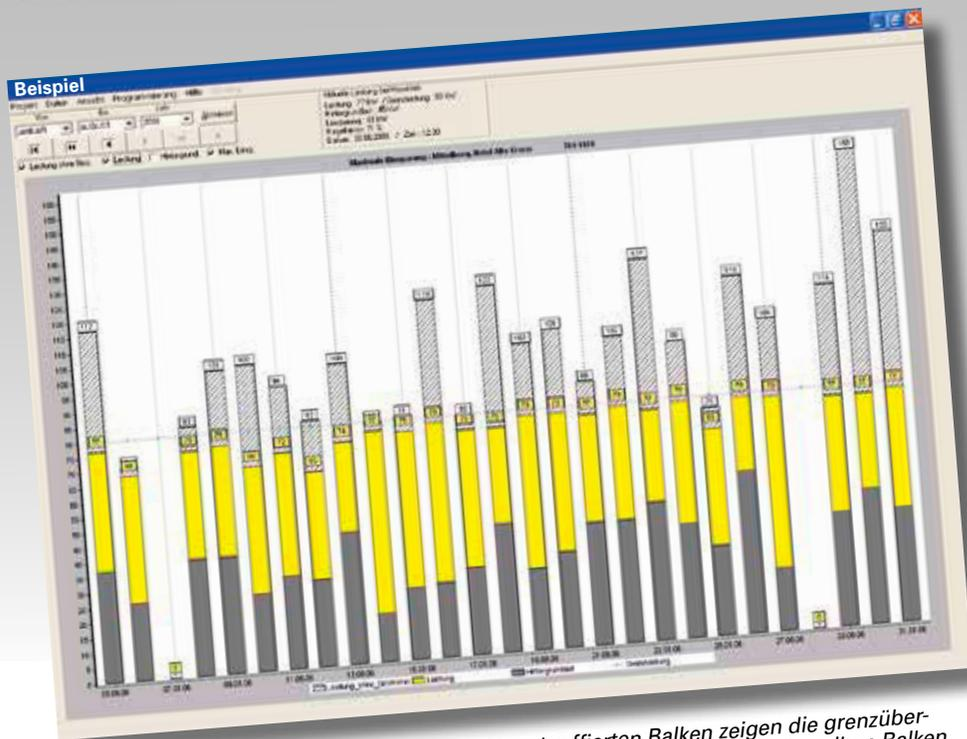
Verschiedene Tageswerte in einem Hotel: Die schraffierten Balken zeigen die grenzüberschreitenden Werte, wenn keine Energieoptimierung eingesetzt würde, die gelben Balken die geregelte bzw. optimierte Leistung, die Grauen bilden die Hintergrundlast ab, während die gestrichelte Linie die Grenzleistung, die nicht überschritten werden soll, markiert.
